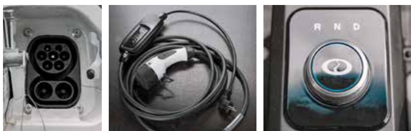
Konektor CCS za spajanje na DC i AC punjače Kružni selektor pogona
