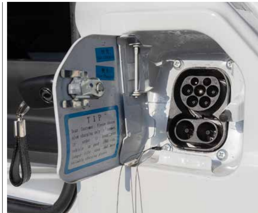
Konektor CCS Combo 2 omogućuje spajanje na DC i AC punjače
